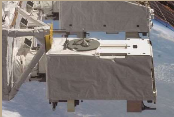
国際宇宙ステーションに取り付けられた 全天X線監視装置 MAXI(マキシ) ©NASA
