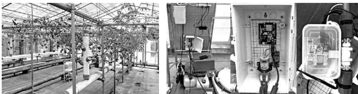
図2 ハウス内の水耕栽培装置(左)と液肥・注水制御装置(右)
