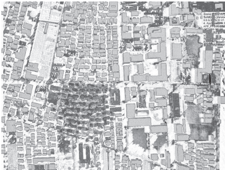
図7 堺南コミュニティ通りや、富士見通りの道路幅での火災の延焼遅滞が見られた
